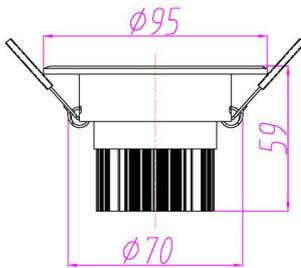
Downlight de alta luminosidad con efecto de luz perfecta, alto brillo y baja atenuación de la luz. Dispone de una vida útil de más de 50.000h de uso. Su carcasa de aluminio le proporciona un alto rendimiento de la disipación del calor.
