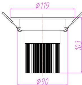
Downlight de alta luminosidad con efecto de luz perfecta, alto brillo y baja atenuación de la luz. Dispone de una vida útil de más de 50.000h de uso. Su carcasa de aluminio le proporciona un alto rendimiento de la disipación del calor.
